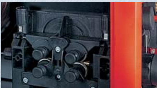
Fuente de energía equipada de accionamiento a 4 rodillos para un transporte de hilo preciso y exento de fallos
