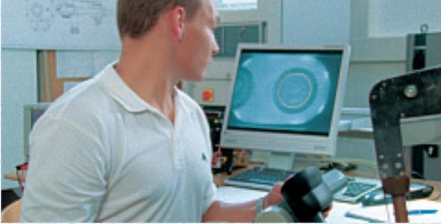
Cada punto se documenta directamente después de la soldadura y se comprueban la calidad, el diámetro, el tamaño, la posición de puntos y las salpicaduras. De este modo se pueden extraer conclusiones al 100%.
