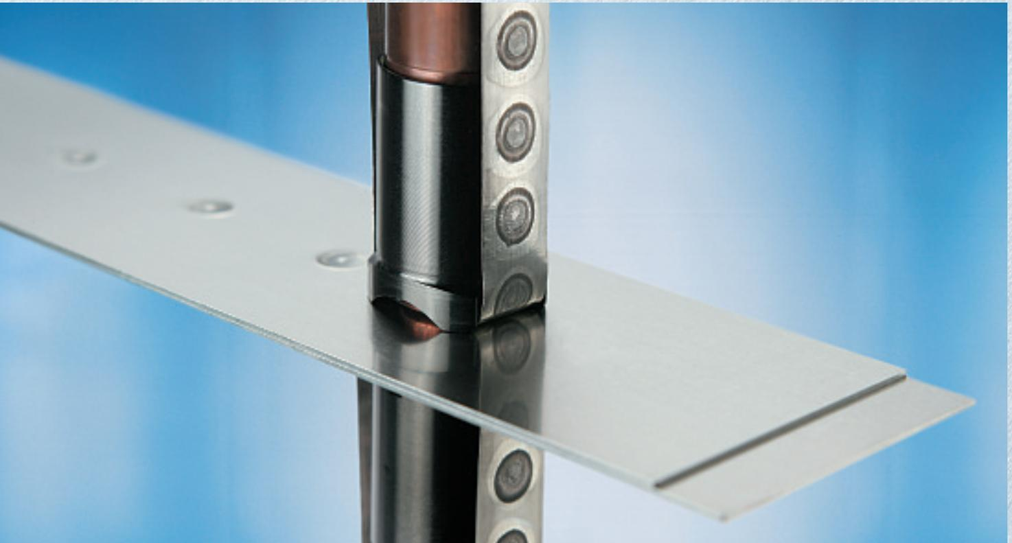
*La cinta de proceso afecta al régimen térmico, por lo que se requiere una menor corriente de soldadura. De este modo se pueden utilizar fuentes de corriente con una potencia relativamente baja para DeltaSpot. Además, la cinta de proceso influye activamente sobre la posición del núcleo de soldadura. A pesar de las diferentes resistencias de material, se realiza la soldadura de todas las chapas.*
