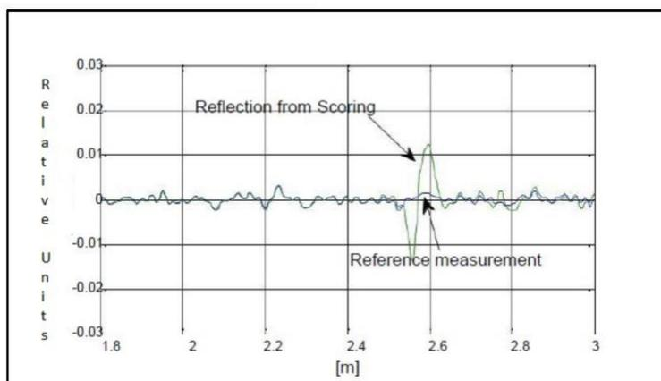
Figura 4: Un segmento de una medición que muestra un reflejo de la puntuación de la pared del tubo, frente a una medición de referencia. La puntuación crea una ampliación local de la sección transversal; por lo tanto, la reflexión es un pulso negativo seguido de un pulso positivo.
