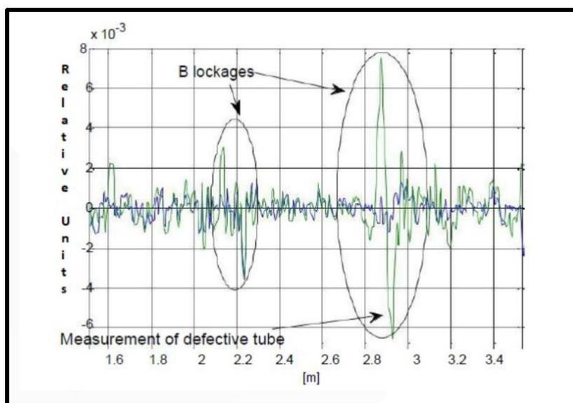
Figura 8. Señales de bloqueos debido a suciedad.
