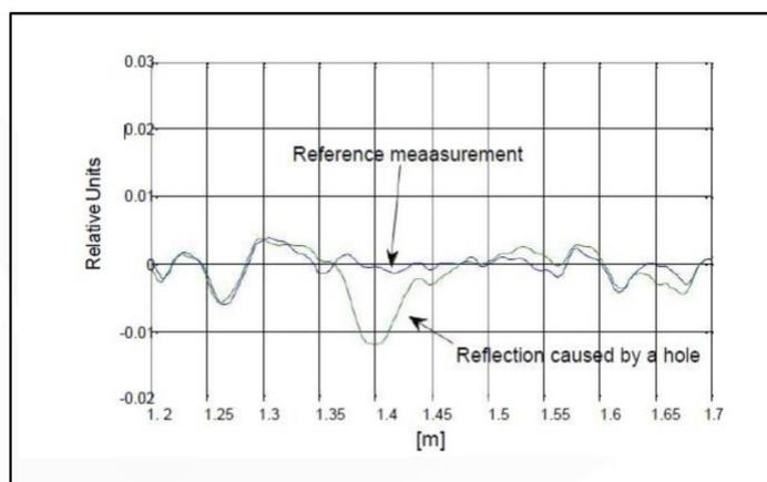
*Figura 3: Un segmento de una medición que muestra un reflejo de un orificio en la pared del tubo, frente a una medición de referencia del tubo sin orificio.*
