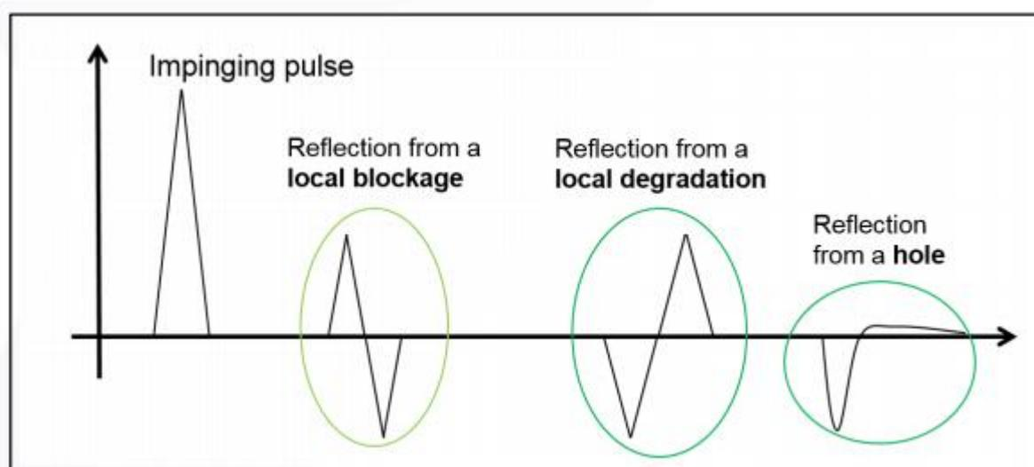
*Figura 1: ejemplos esquemáticos de reflexiones de discontinuidades*
