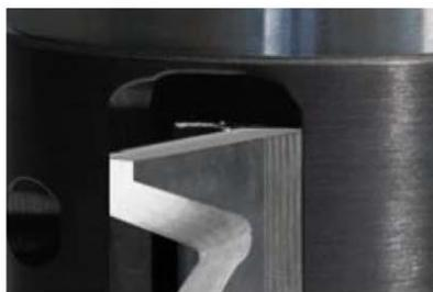
Perfilado de fresa soldada
