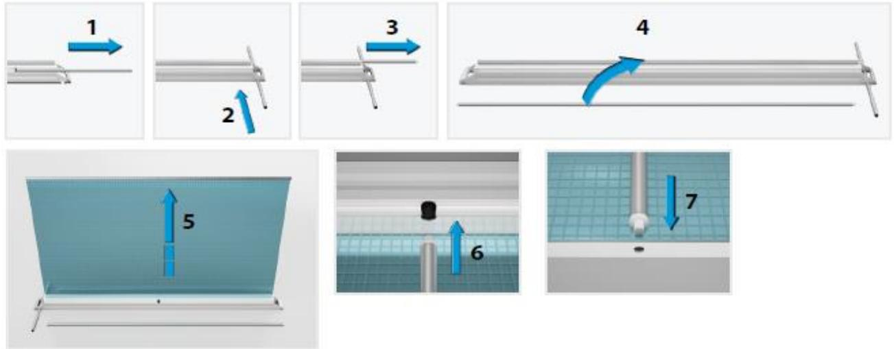
El material de la banda está realizado con nuestro TEMAT-198 que es translúcido para dejar pasar la luz y no generar opacidad en el área protegida, dicha banda de PVC tiene un espesor de 0,5 mm y es de muy fácil limpieza. Ofrece óptima resistencia a la abrasión, cortes y ozono. Tiene una buena resistencia ante los ácidos.
