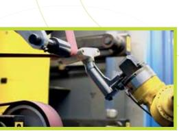
Las unidades de esmerilado se ensamblan en sistemas patentados de autocompensación.
