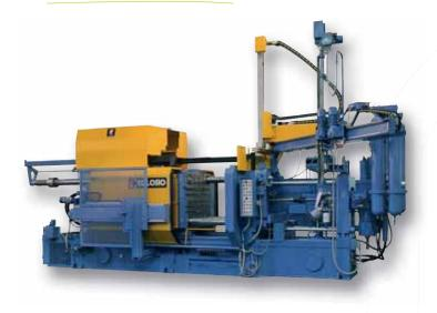
Productividad y eficiencia gracias a la constante innovación tecnológica, a la estructura extremadamente robusta, a las elevadas velocidades de inyección (incluso para el magnesio), a los reducidos tiempos de ciclo y a la inyección de doble circuito.
