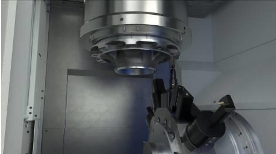
Para finalizar tiene lugar el acabado de la pieza y el fresado de las ranuras. En este caso también se utiliza una torreta revólver con herramientas motorizadas para realizar las roscas en los taladros.
