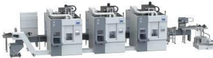
Un sistema perfectamente configurado y diseñado para una máxima productividad y de un solo proveedor: las máquinas, el sistema de automatización, la secuencia de automatización, los periféricos, los medios de sujeción, las herramientas y la tecnología, todo ello optimizado por los expertos de EMAG
