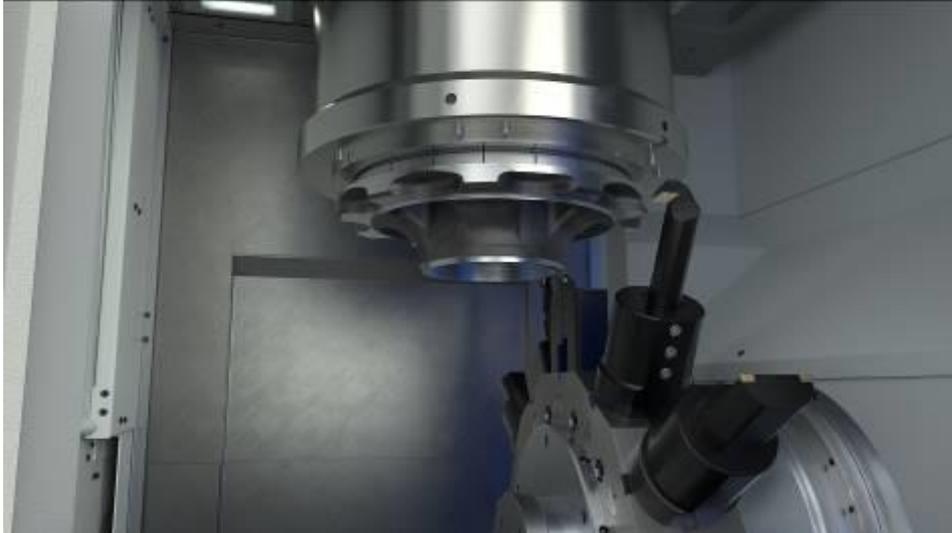
En la primera operación tiene lugar el torneado del contorno exterior e interior del cubo de rueda. El desbastado y el acabado del primer lado se realizan en una misma sujeción.
