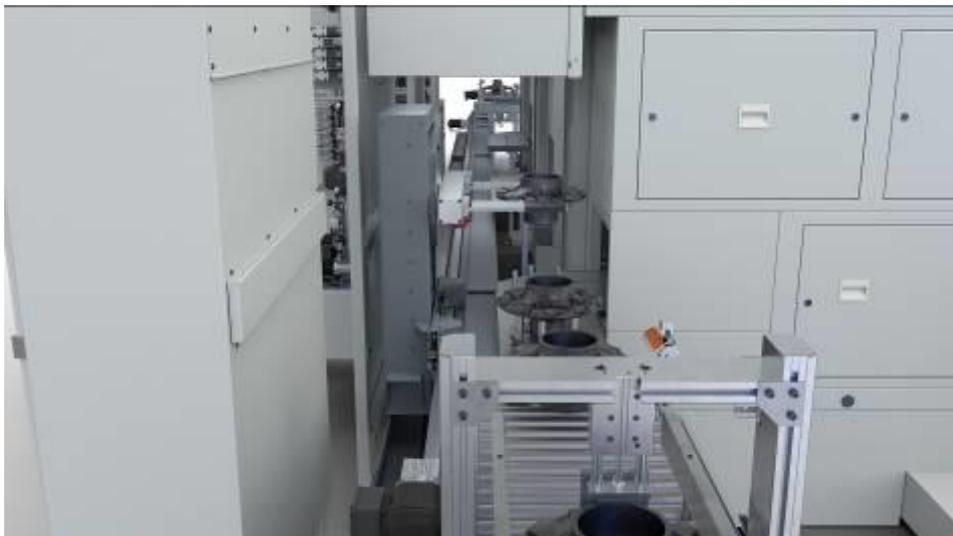
El sistema TrackMotion propio EMAG. En este sistema de automatización, una unidad de pinza se desplaza linealmente sobre un carril ("track").
