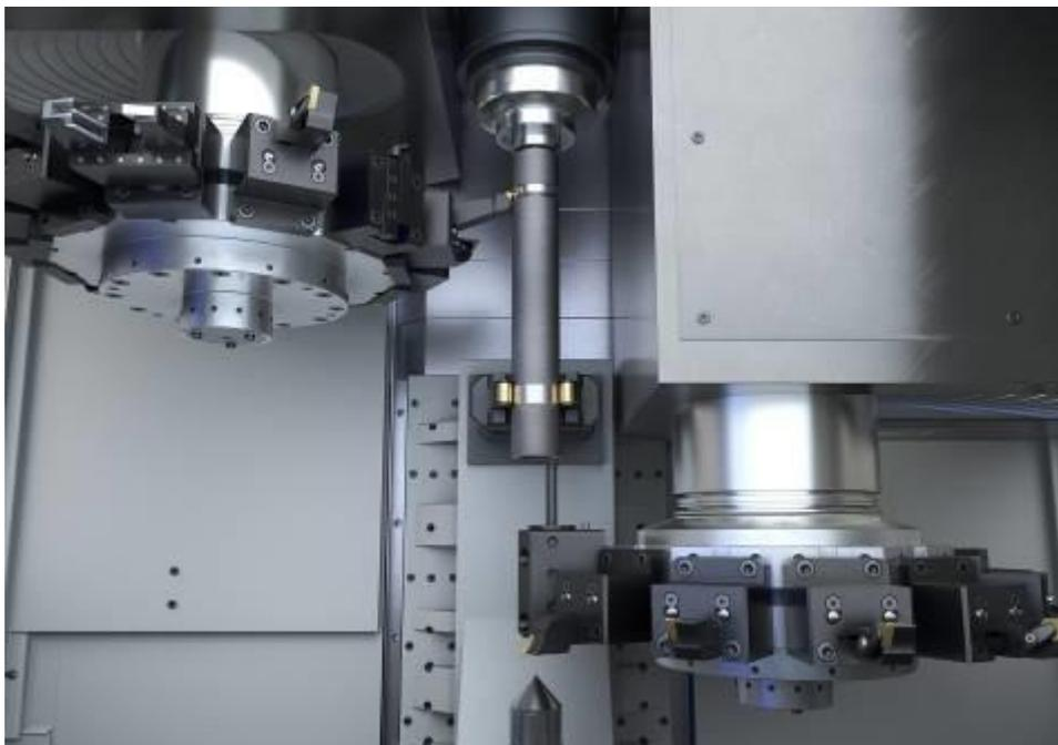
OP 10 / 20 – Torneado de desbaste en dos VTC 200 de EMAG: una solución perfecta para el mecanizado de árboles en 4 ejes con tiempos principales más cortos.
