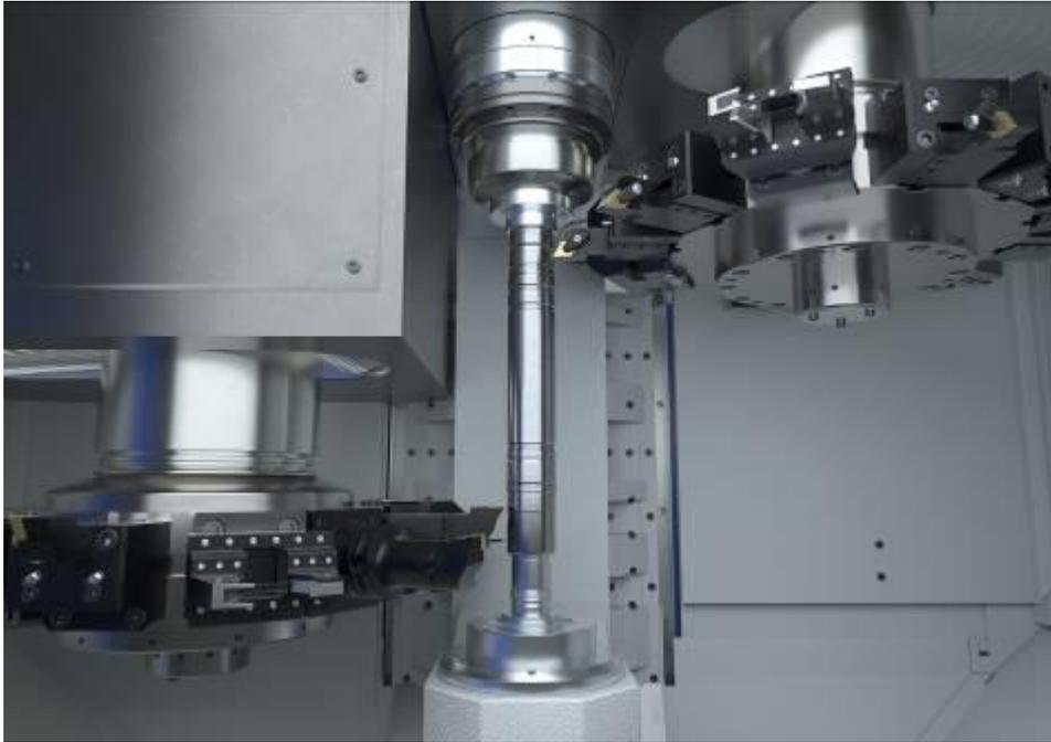
OP 60 – Torneado de precisión y taladrado con herramientas motorizadas en una VTC 200.
