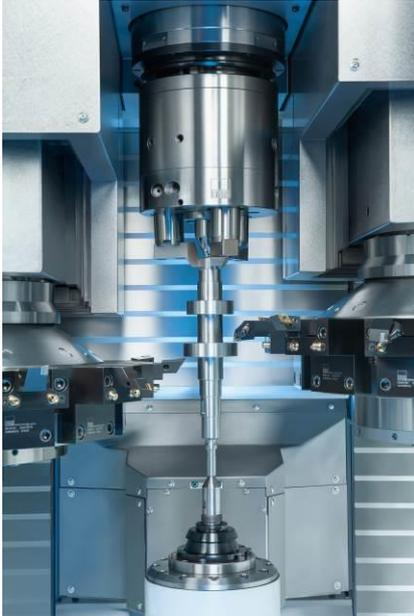
VT 4: mecanizado en 4 ejes de altos volúmenes de ejes para cajas de cambio
