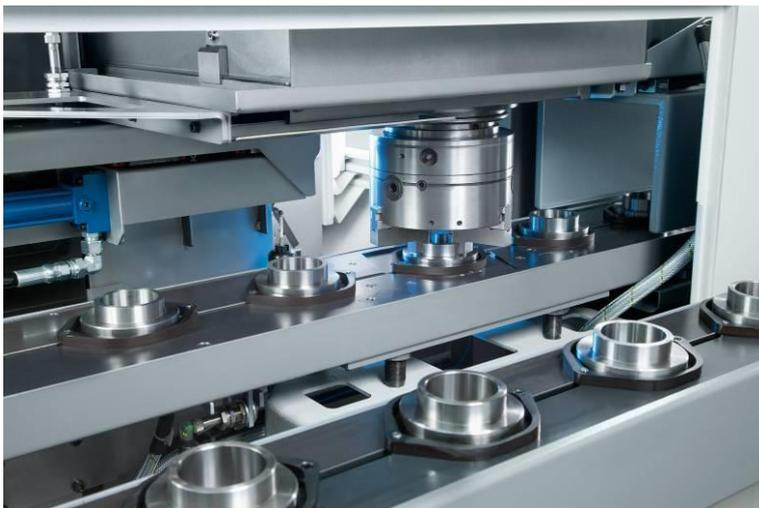
El transporte de las piezas tiene lugar mediante un sistema de automatización circular. La carga y descarga de la VL 2 funciona según el principio pickup.
