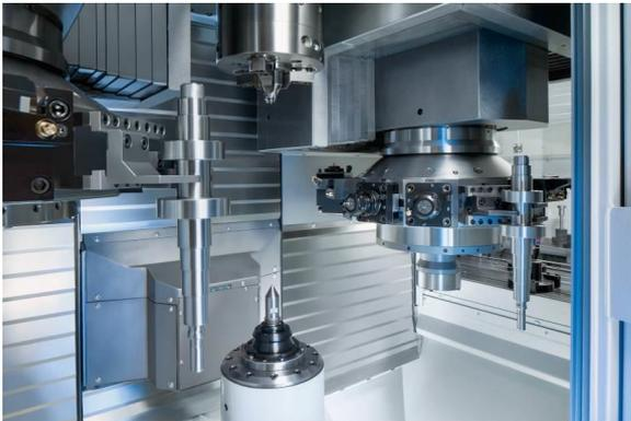
La máquina VT se carga y descarga mediante pinzas en ambas torretas portaherramientas. La alimentación de piezas se realiza mediante bandas automatizadas laterales.
