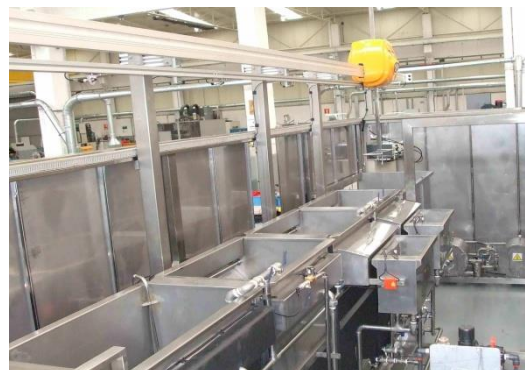
Línea automática con detergentes y horno de secado
