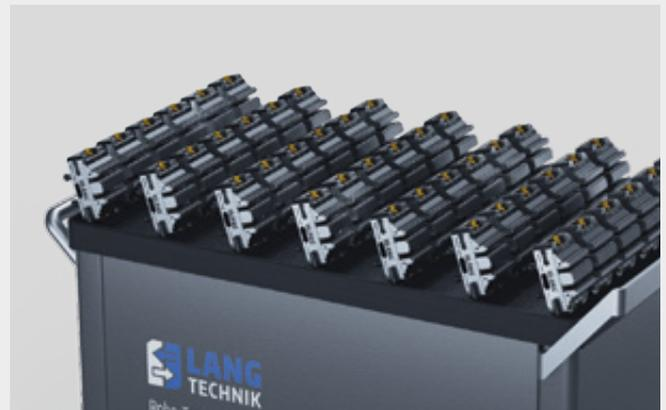
La garra central ahora puede ser montada en la mordaza Makro·Grip® ejes para la automatización Robo-Trex. Esto aumenta la capacidad de la automatización considerablemente.
