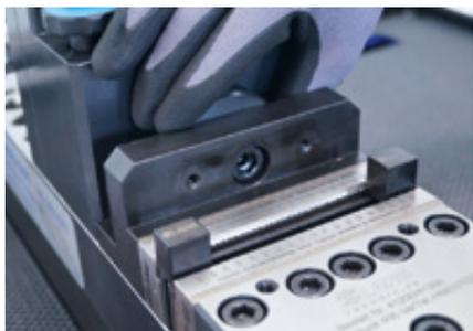
Introducir las dos galgas en los extremos de las bocas. Apretar las bocas sólo con la mano, no accionar el interruptor!
