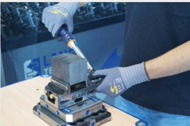
Para un proceso de sujeción fiable y segura, se recomienda el uso de una llave dinamo-métrica.
