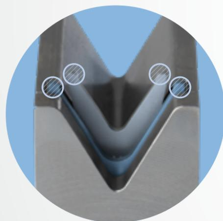
El corazón del sistema es el **sensor** con doble horquilla conformada con **4 puntos de contacto**: éste detecta, en contacto con el material, el ángulo de plegado por ambos lados de la chapa y envía al sistema los datos para realizar el plegado.
