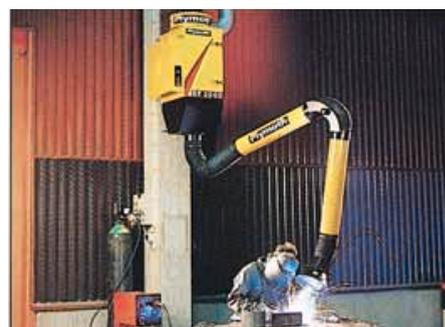
Brazo KUA de PlymoVent montado directamente sobre un filtro EF
