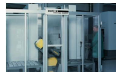
Placa de policarbonato transparente y pulida que ofrece extrema protección al impacto, alta claridad óptica, y buena resistencia al fuego.
