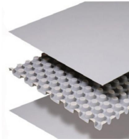
Las placas VikuBoard CP 4.8 se componen de 3 capas de hojas de PP. El núcleo de las placas presentan una estructura de picotas, tridimensionales y termoformado en hojas de PP. El PP se pliega infinitamente sin romper, por incisión y por fresado en V.
