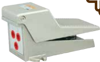
F522C-08L Pedal metálico función 5/2, rosca 1/4, con enclavamiento y carcasa protectora.
