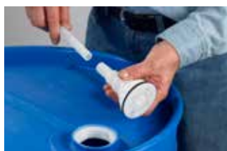
Introducir el DIP-TUBE en el agujero del DRUM INSERT
