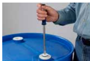
Fijarlo fuertemente mediante una llave o destornillador.
