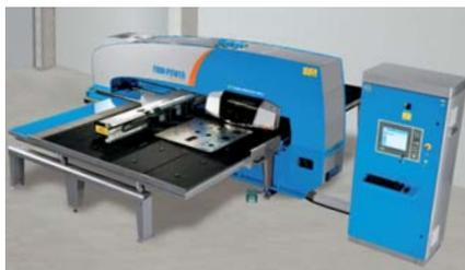
Punzonadoras servo-eléctricas e hidráulicas de torreta, desde modelos básicos a los más sofisticados de altas prestaciones, amplia gama de configuraciones de carga y descarga y total integración con almacenes y FMS.
