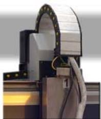
Este modelo utiliza dos **bancadas independientes** para aislar la rejilla de corte de los ejes de movimiento de la máquina, evitando la transmisión de impactos y vibraciones.
