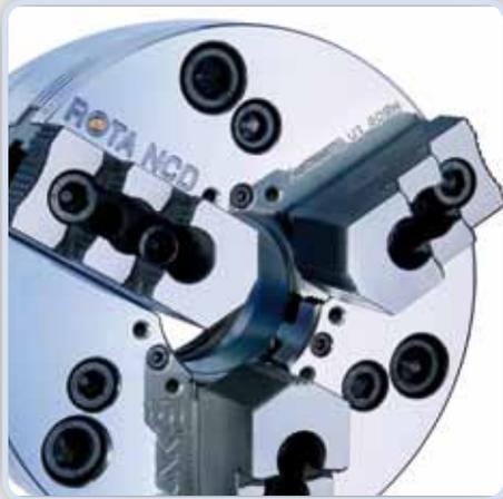
El plato **ROTA NCD** se basa en la idea patentada de amarre de precisión de piezas pequeñas con las **garras-pinzas** de Schunk, que se acoplan tanto en el dentado normal de las garras base como en el dentado existente en el diámetro interior de las garras base, al mismo tiempo es posible amarrar piezas de grandes dimensiones con garras convencionales.
