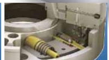
Sistema integral de bomba de engrase en el sistema de compensación de fuerza centrífuga. Para recirculación de grasa en cada ciclo de amarre. Los intervalos de engrase se ven aumentados.
