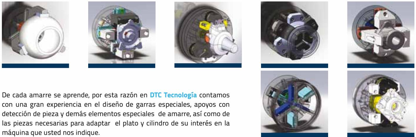
De cada amarre se aprende, por esta razón en **DTC Tecnología** contamos con una gran experiencia en el diseño de garras especiales, apoyos con detección de pieza y demás elementos especiales de amarre, así como de las piezas necesarias para adaptar el plato y cilindro de su interés en la máquina que usted nos indique.
