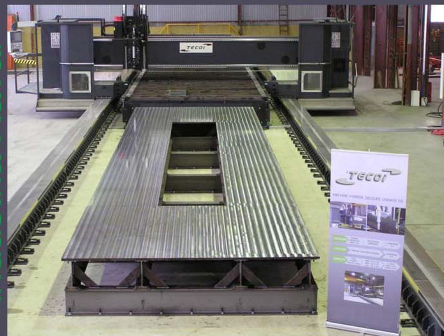
La máquina TRF es la solución para los requerimientos más exigentes en cuanto a la normativa referente a la preparación de bordes para soldadura.
