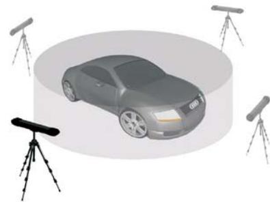
**Dispositivo realmente portátil.** La portabilidad absoluta de MetraSCAN permite realizar inspecciones o ingeniería inversa en partes, subunidades o ensamblajes complejos con una precisión, movilidad y flexibilidad inigualables, sin importar el lugar de trabajo (laboratorio, fábrica, fuera de la planta, etc.).
