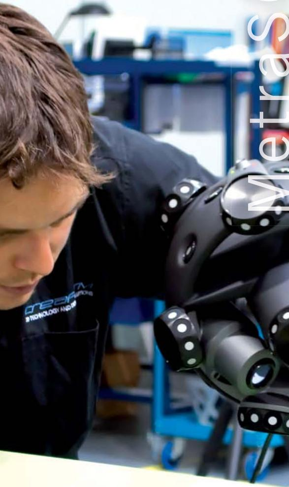
**Solución de inspección completa y potente.** Permite la inspección geométrica y de forma libre en la misma pieza con el mismo sistema. La capacidad de **alineamiento automático** con reflectores ópticos permite escanear y sondear varias piezas idénticas en rápida sucesión.
