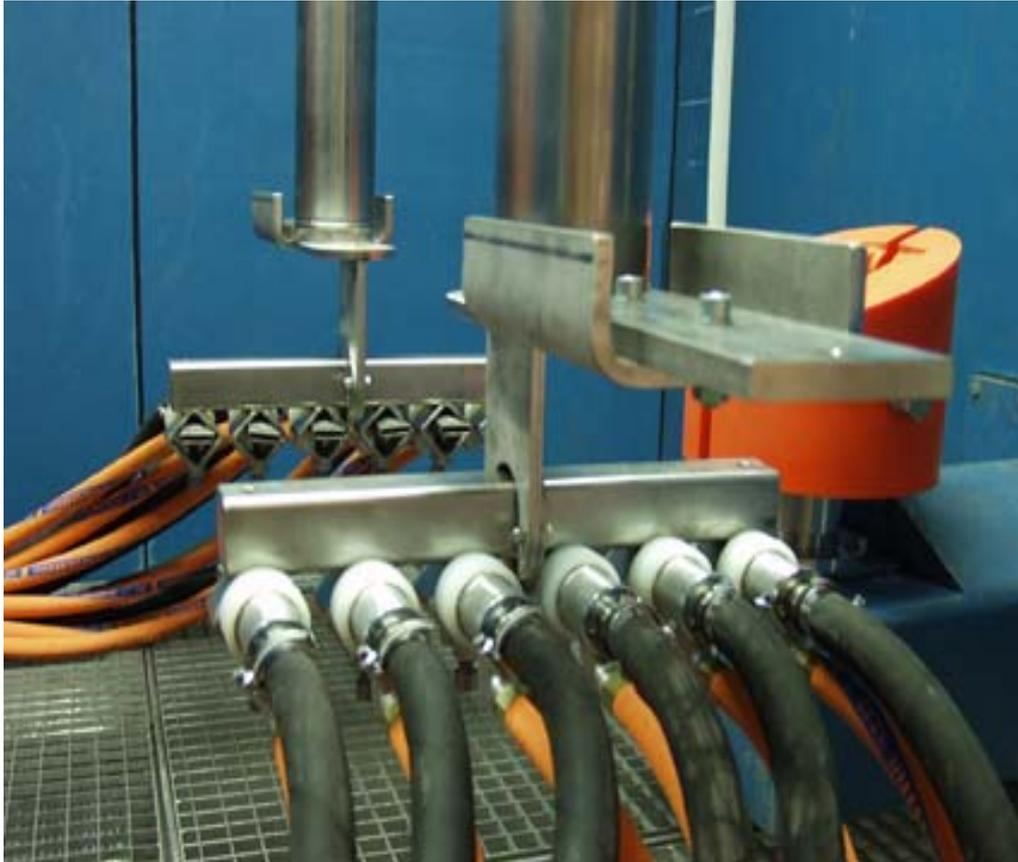
Las palas de turbinas se sujetan y colocan en una estación rotativa de satélite. Las 12 boquillas de chorreado se mueven mediante un CNC multi-eje que garantiza una precisión de 0,1mm. El líquido consistente en una mezcla de agua y abrasivo, es acelerado en la pistola de chorreado mediante aire comprimido.
