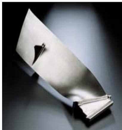
A los componentes de turbinas, como por ejemplo, palas de turbina, se les aplica un proceso de shot peening para inducirles tensión residual compresiva en la capa superior de la superficie de las piezas. Este proceso se aplica tanto a componentes de nueva fabricación como a restaurados.
