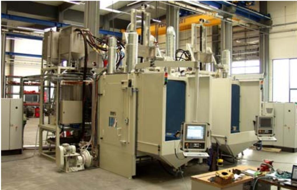
El sistema de granallado en húmedo está diseñado para el shot peening de 14 piezas diferentes de palas de turbinas con un largo máximo de 1.150 mm. Equipado con dos cabinas de granallado de acero inoxidable, el sistema garantiza un alto rendimiento de piezas.
