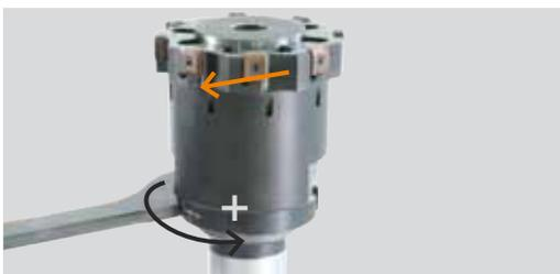
Observar la marca en el portaherramientas y en el anillo, comprobar que los agujeros de refrigeración están alineados. Ajustar el diámetro a la mitad de la tolerancia.
