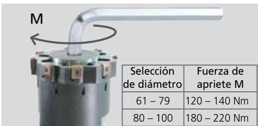
Atornillar la tuerca en el porta con la cara suave contra el buje. Montar el anillo Duomax con el tornillo cónico. Una vez apretado, comprobar que queda un espacio entre el buje y el anillo. Apretar el tornillo cónico en función de las tablas adjuntas.
