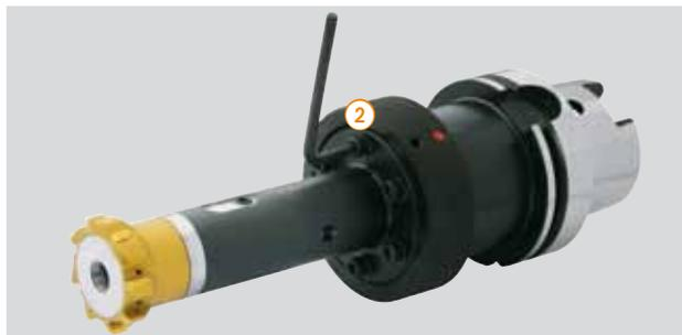
Efectuar pretensado de forma uniforme con los 6 tornillos de ensamblaje ② (presionando la arandela de muelle).
