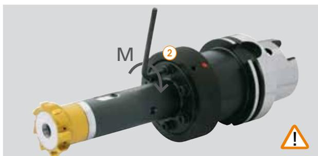
Apretar los tornillos ② por pares opuestos. Observar par de torsión inicial M indicado en la tabla-índice. Una vez fijado, fije el anillo de ajuste ① mediante el bloque del pasador ④.
