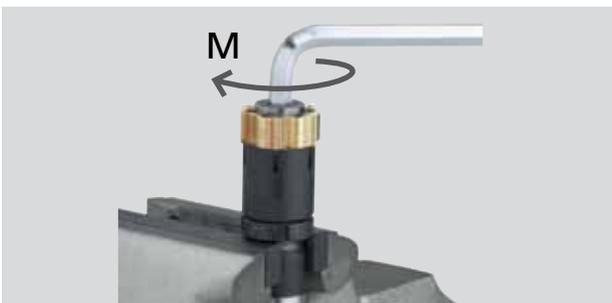
Apretar la rosca en el porta-útiles con la cara suave dispuesta contra el buje. Monte el anillo de corte con el tornillo cónico.
