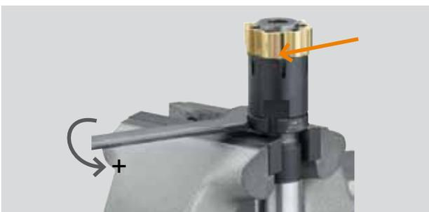
Por favor observar las marcas en el porta-útiles y el anillo de corte. Comprobar la alineación de los agujeros de refrigerante.
