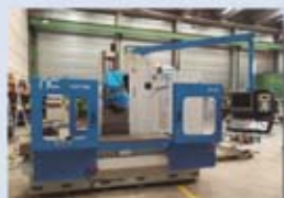
Fresadora CORREA CF22/20 cnc HEIDENHAIN TNC 426 Recorridos 2000x800x800 mm.
