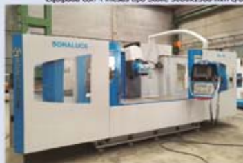
Fresadora bancada fija SORALUCE TA 20 cnc HEIDENHAIN TNC 426. Recorridos 2000x800x800 mm
