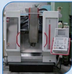
Centro HERMLE C-800 U 4 EJES cnc HEIDENHAIN TNC430 recorridos 800-500-450 mm.
