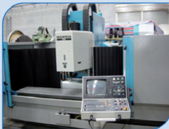
Centro de mecanizado IBARMIA ZVX-2000 cnc HEIDENHAIN TNC-407 recorridos 2000x500x500 mm.
