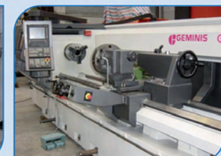
Torno GEMINIS GHT4 G2 CNC SIEMENS 810 D E.P. 3000 x Ø 720 mm , torreta automática SAUTER
