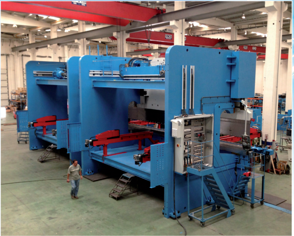
Línea automática de plegado: 2 plegadoras en tándem, 3000 toneladas y 16 metros.
