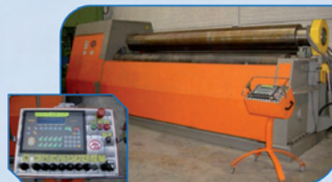
Cilindro MG de 4 rodillos mod. MH 4020E con CN longitud 4000 x 20 mm espesor y precurado de 16 mm.
