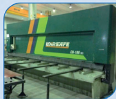
Cizalla LOIRE SAFE CH106 con CN ELGO 1 eje 6050 x 10 mm.
