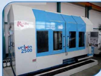
Centro de mecanizado KONDIA URBAN 2500 cnc HEIDENHAIN TNC 426 recorridos 2500-500-610 mm.
