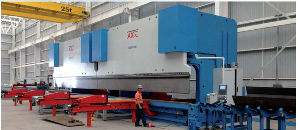
Línea automática de plegado: 2 plegadoras en tándem, 3000 toneladas y 16 metros.
