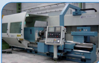
Torno GURUTZPE A1000/3 CNC FANUC 21 i TB E.P. 2000 x Ø 870 mm Equipado con luneta hidráulica.
