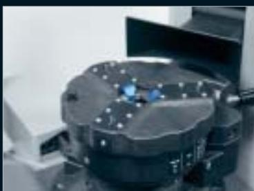
00:32 La bobina de inducción se desplaza automáticamente y empieza el calentamiento
