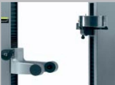
Unidad de sujeción giratoria para medir y ajustar herramientas largas sin el sistema TRIBOS.
