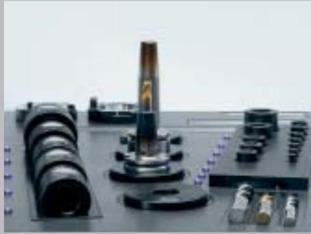
Unidad auxiliar para alojar la electrónica de contracción, campanas de refrigeración, anillos de sujeción, »masterPiece« de ZOLLER y unidades de reajuste.
