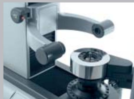
Posicionamiento automático de la unidad de sujeción Schunk TRIBOS en la posición de contracción.
