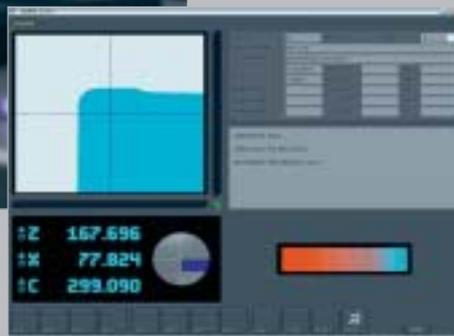
El sistema de gestión de contracción »s.l.s.« indica al usuario gráfica y ópticamente el accesorio que se necesita en cada momento, los pasos de manejo y el status actual – de forma ergonómica, rápida y segura.
