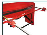
hinterer Anschlag mit Feinjustierung back side fence with vernier system
