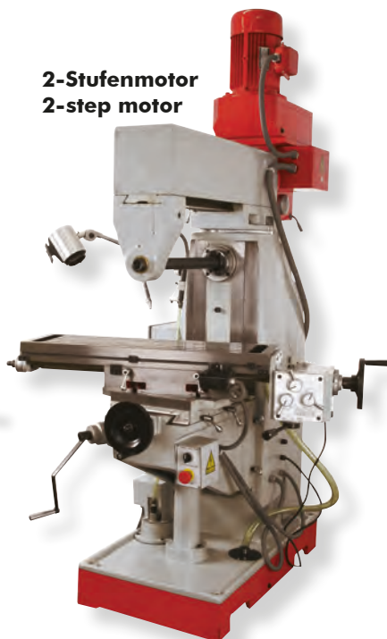
BF500DDRO mit 3-Achs Digitalanzeige BF500DDRO with 3-axis DRO
