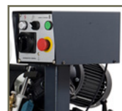
Panel de control con selector de bajada manual o controlada
