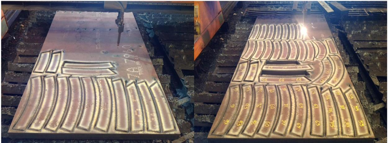
B) Repasado / desbarbado y estabilizado horno de los sectores + mecanizado.
