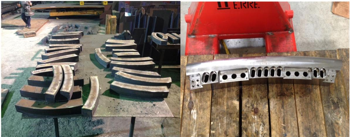
C) Construcción de la estructura de la prensa, instalación de la matriz y primeras pruebas de hidroconformado con chapas de aluminio de 4 y 5 mm de espesor.
