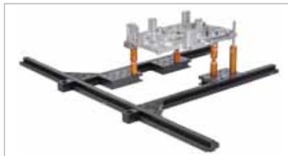
Los sistemas de sujeción de rieles rápidos para equipos de medición táctil y visual son herramientas sumamente simples y fáciles de usar una vez montadas en la MMC, y permiten al usuario fijar la muestra con gran rapidez. Ya que la instalación de los rieles lleva muy poco tiempo, tiene sentido montarlo incluso para piezas individuales. Nuestros rieles rápidos patentados también son compatibles con todos los componentes Mitutoyo y, por lo tanto, se puede ampliar a un precio muy asequible.
