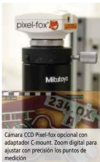
Cámara CCD Pixel-fox opcional con adaptador C-mount. Zoom digital para ajustar con precisión los puntos de medición
