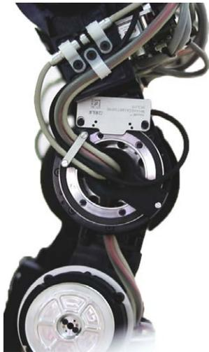
Articulación de la rodilla del REEM-C con el sistema de encóder rotatorio absoluto AksIM™
