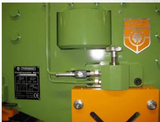
Pisador hidráulico para perfiles y chapa
