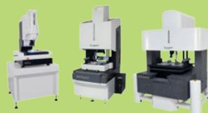
La flexibilidad es el tema clave en la tecnología de multisensores. La flexibilidad en el mundo de la metrología significa tener la libertad de elegir entre medición por contacto y medición óptica, con sólo un sistema de medición. Por lo tanto, un único sistema es suficiente para la medición por contacto y la medición óptica de todas las características de inspección en una pieza de trabajo.
