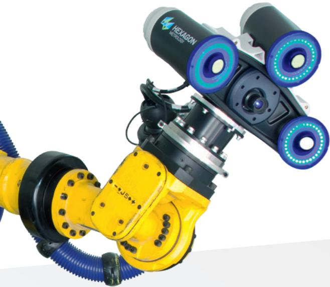
① **Célula de medición automatizada con los últimos avances tecnológicos WLS y Láser-Tracker.**
