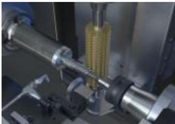
Un vistazo al espacio de trabajo: la gran distancia entre ejes, de hasta 130 milímetros, y un cabezal de fresado de 28 kW de potencia garantizan una gran flexibilidad y eficiencia.
