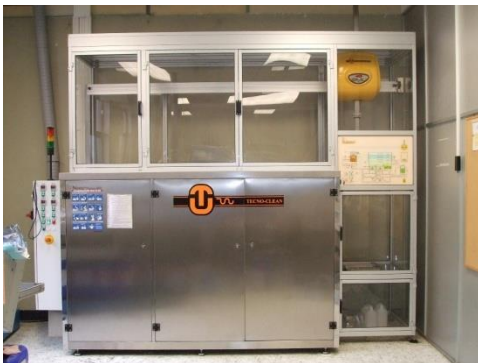
Limpieza de circuitos electrónicos militares
