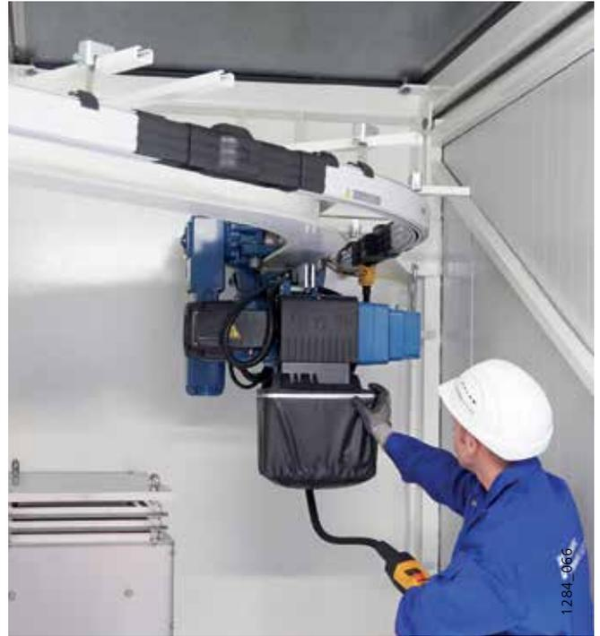
Carro para tramo curvo: altura reducida con velocidad sin escalonamientos
