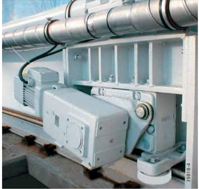
Arquitectura móvil con unidades de traslación Demag, formadas con motorreductores angulares, conjuntos de rueda integrados y rodillos guía
