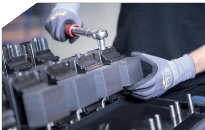
El sistema patentado de colocación de las mordazas Makro·Grip® Robo asegura un buen utilización del espacio así como una buena accesibilidad a realizar el amarre de las piezas.
