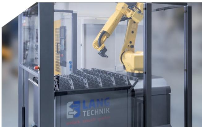
La instalación del Robo·Trex se puede realizar a maquinas ya existentes automatizando las puertas así como sacando función M para la comunicación entre maquina y Robo·Trex
