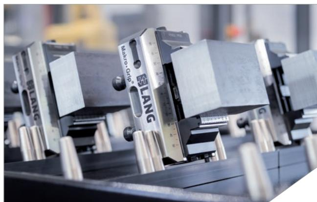
Para poder alinear y sujetar el cuerpo del Makro·Grip® 77 se realizan unos mecanizados por las dos partes así como un pequeño vierteaguas.
