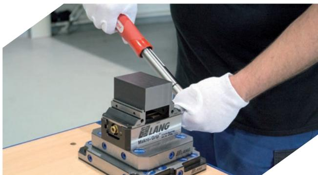
Para un proceso de sujeción fiable y segura, se recomienda el uso de una llave dinamo-métrica
