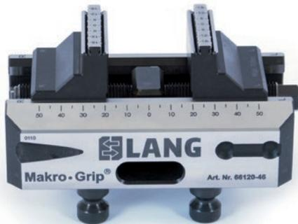
Nuevo formato de mordaza diseñada para ser manejada con un Robot, dispone en los laterales de un mecanizado para poder posicionarla sobre el carro de carga y descarga. También dispone de un mecanizado en rampa que favorece la evacuación de viruta y taladrina, así como un husillo mejorado con mayor repetibilidad y fuerza en el amarre. Gracias a todo esto ahora podemos intercambiar bocas de 77 y 46 mm, según necesidades del mecanizado.
