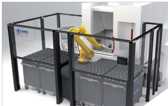
Opcionalmente el Robo·Trex se puede equipar con 4 carros de carga utilizando un espacio de 2,20x3,70m para aumentar la capacidad de 120 a 168 Makro·Grip® dependiendo del tamaño de la pieza.
