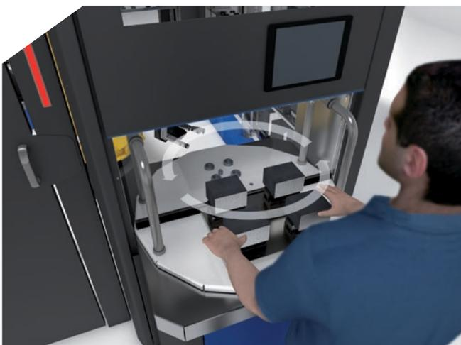
El puesto de carga con mesa giratoria. El robot almacenara el pallet mientras preparamos el siguiente pallet.
