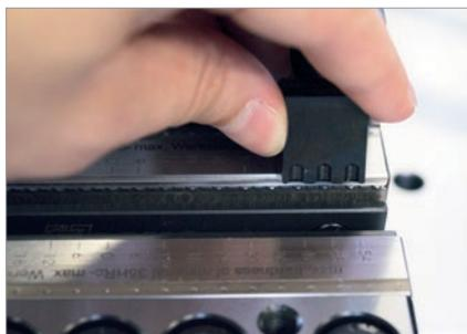
Asegúrese de que los dientes de las bocas están colocadas en las ranuras de la calibración bloques
