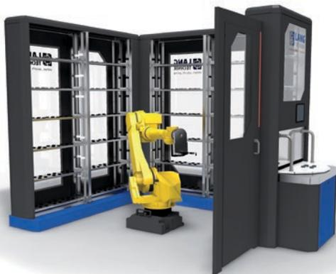
El sistema de automatización Robo·Shelf destaca por la versatilidad de opciones y tamaños de piezas de trabajo de montaje. El robot automatizado es capaz de trabajar con pesos de hasta 60 kg y suministra directamente a la máquina herramienta con mordazas y / o montajes propios / bandejas. Dependiendo de la interfaz de la máquina cada pallet del sistema de estanterías puede ser seleccionado individualmente en la máquina herramienta.
