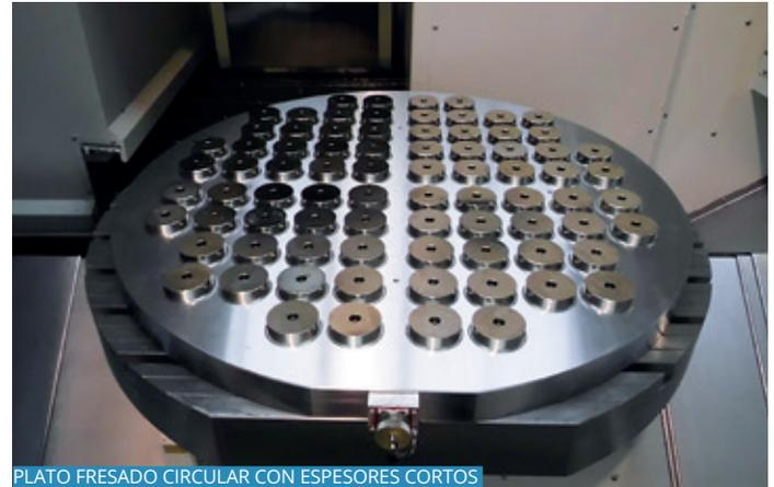
PLATO FRESADO CIRCULAR CON ESPESORES CORTOS
