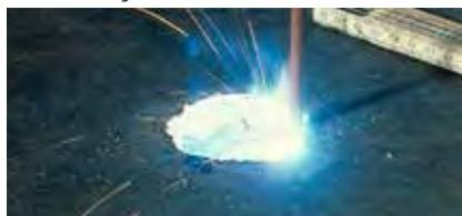
Acanalado con ChamferTrode
