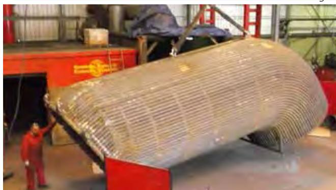
Conducto de salida de gases
