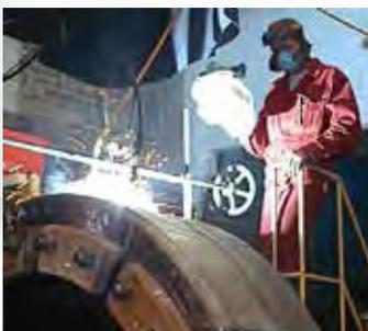
Revestimiento anti-desgaste empleando el proceso TeroMatec® y Arco Sumer-gido
