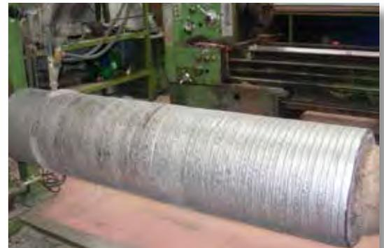
Rodillo Siderurgica recargados con procedimiento EnDOtec
