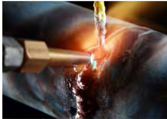
Soldadura acero galvanizado con varilla y decapante 18
