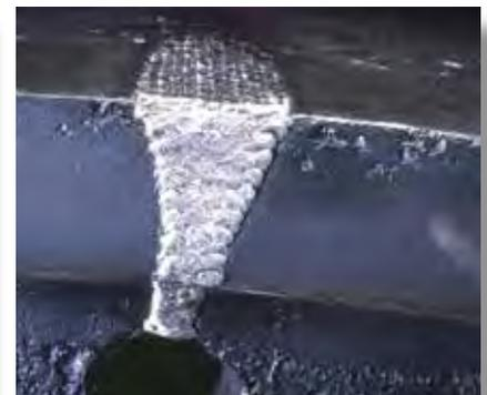
Un bajo aporte térmico consigue que nuestros electrodos EutecTrode minimicen las tensiones residuales al preconformar grandes soldaduras como las necesarias para reparar hornos de cemento fisurados.
