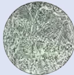
Micro estructura del aporte Xuper 680 S con cristales primarios de orientación aleatoria, que proporcionan una mayor resistencia a los fallos por fisuras.
