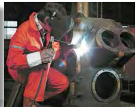
La capacidad de soldar "en posición" hierro fundido "en frío" con Xuper 2240, facilita la reparación de grandes y costosas fundiciones.
