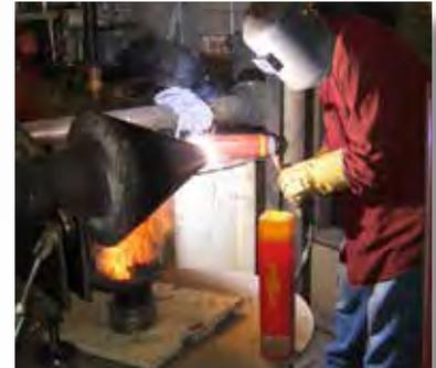
Este electrodo EutecTrode TeroCote conforma un depósito que proporciona protección eficaz contra la abrasión, la erosión y la corrosión, y es ideal para tornillos de transporte de gran duración.
