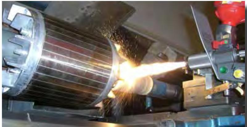
Rotor reparándose con el procedimiento de proyección térmica "en frío" RotoTec®
