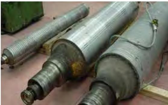
Rodillos con proceso de arco sumergido
