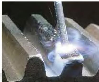
Reparación de defectos de fundición
