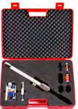
La lanza CastoDyn SF Extra-Flat es una solución cuando el acceso a la zona de recargue representa un problema. Una apertura mínima de 60 mm es suficiente para permitir el acceso de la lanza y la aplicación del recargue. Una aplicación típica es el recargue de decaners con aleaciones altamente resistentes al desgaste. Este conjunto incluye el módulo SSM 51 y una lanza de longitud 380mm
