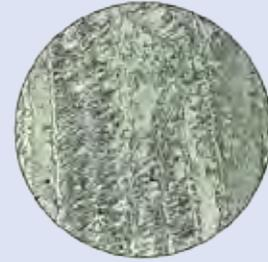
Estructura típica en columnas de un cordón de soldadura tipo 29-9 WS 312, susceptible de sufrir fracturas sometido a cargas mucho más bajas (x 120).
