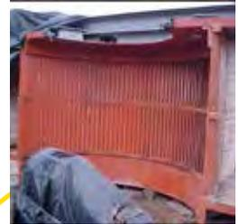
Palas de separador dinámico fabricadas con CDP®
